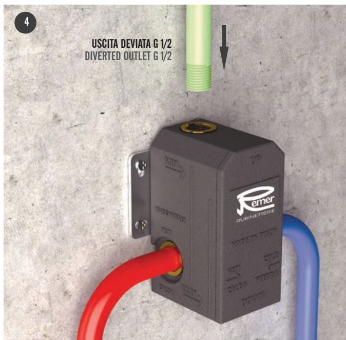
Collegare la tubazione superiore dell'uscita deviata da G 1/2. Connect the G1/2 outlet output upper pipe.
