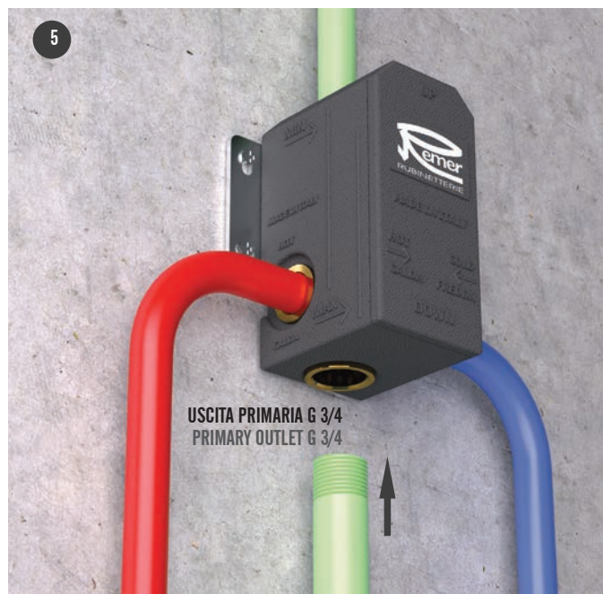
Collegare la tubazione inferiore dell'uscita primaria da G 3/4 (aggiungere una riduzione 3/4x1/2 se desiderate installare due soluzioni doccia) Connect the G3/4 primary output lower pipe (you will need to add a 3/4X1/2 reduction if you wish to install 2 shower solutions)
